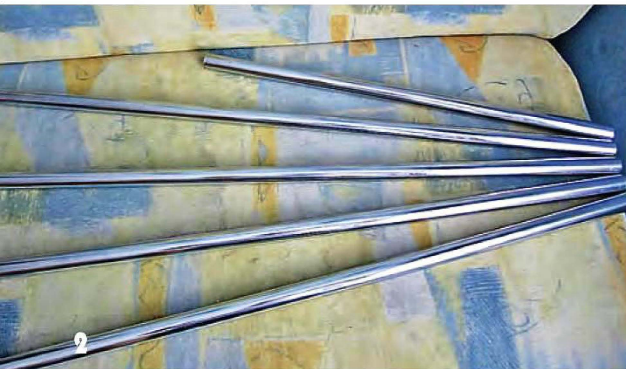
2 Раскроенные по длине хромированные трубы системы Joker.
