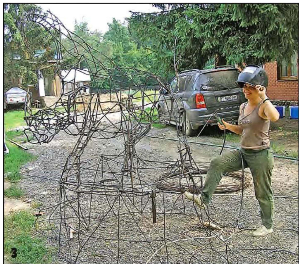
Каркасы всех фигур и элементов построек — сварные, из арматурного прутка.
