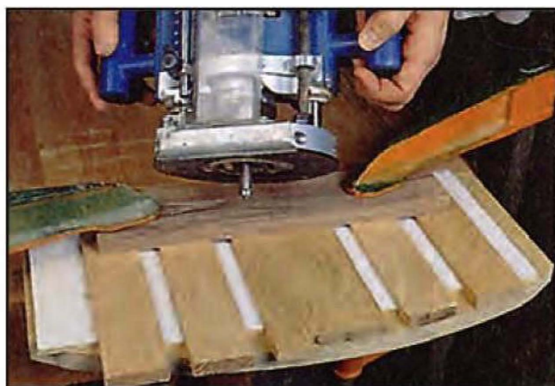
Рис. 2. Приспособление для фрезерования торцов боковых планок.
