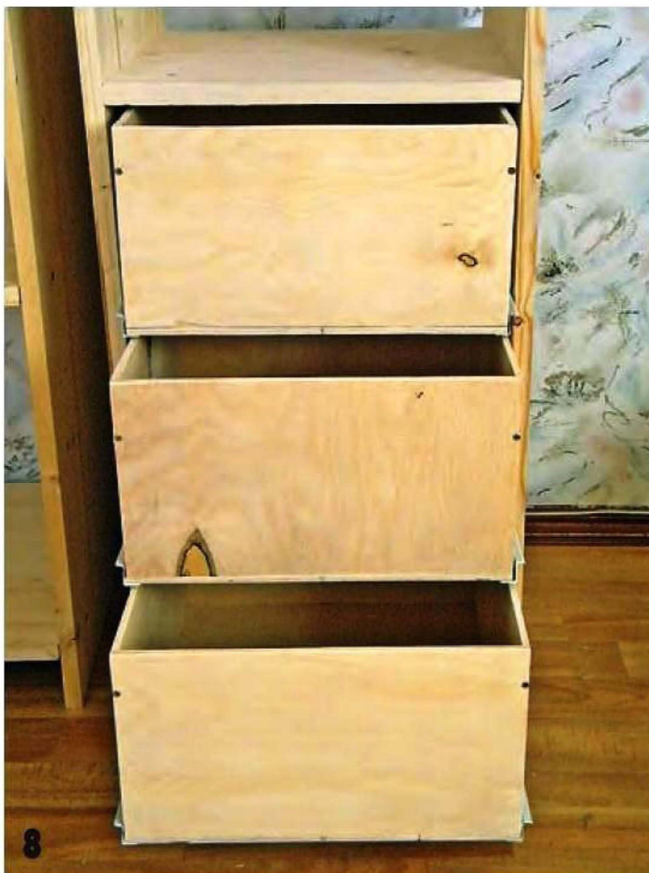
К дну ящика по бокам крепятся направляющие выдвижного механизма, и при выкраивании дна нужно это учитывать.
