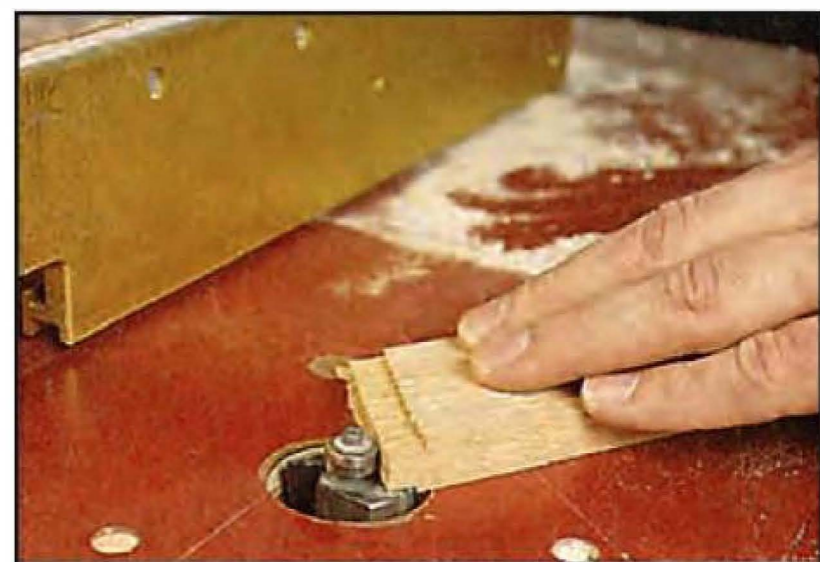
Рис. 2. Приспособление для фрезерования торцов боковых планок.
