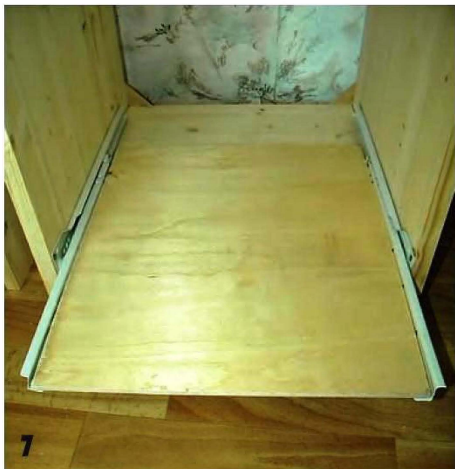
К дну ящика по бокам крепятся направляющие выдвижного механизма, и при выкраивании дна нужно это учитывать.
