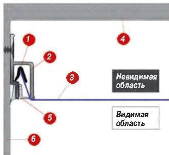
Рис. Схема крепления полотна при помощи гарпуна: 1 — гарпун; 2 — профиль (багет); 3 — полотно натяжного потолка; 4 — базовый потолок; 5 — декоративная заглушка; 6 — стена.
