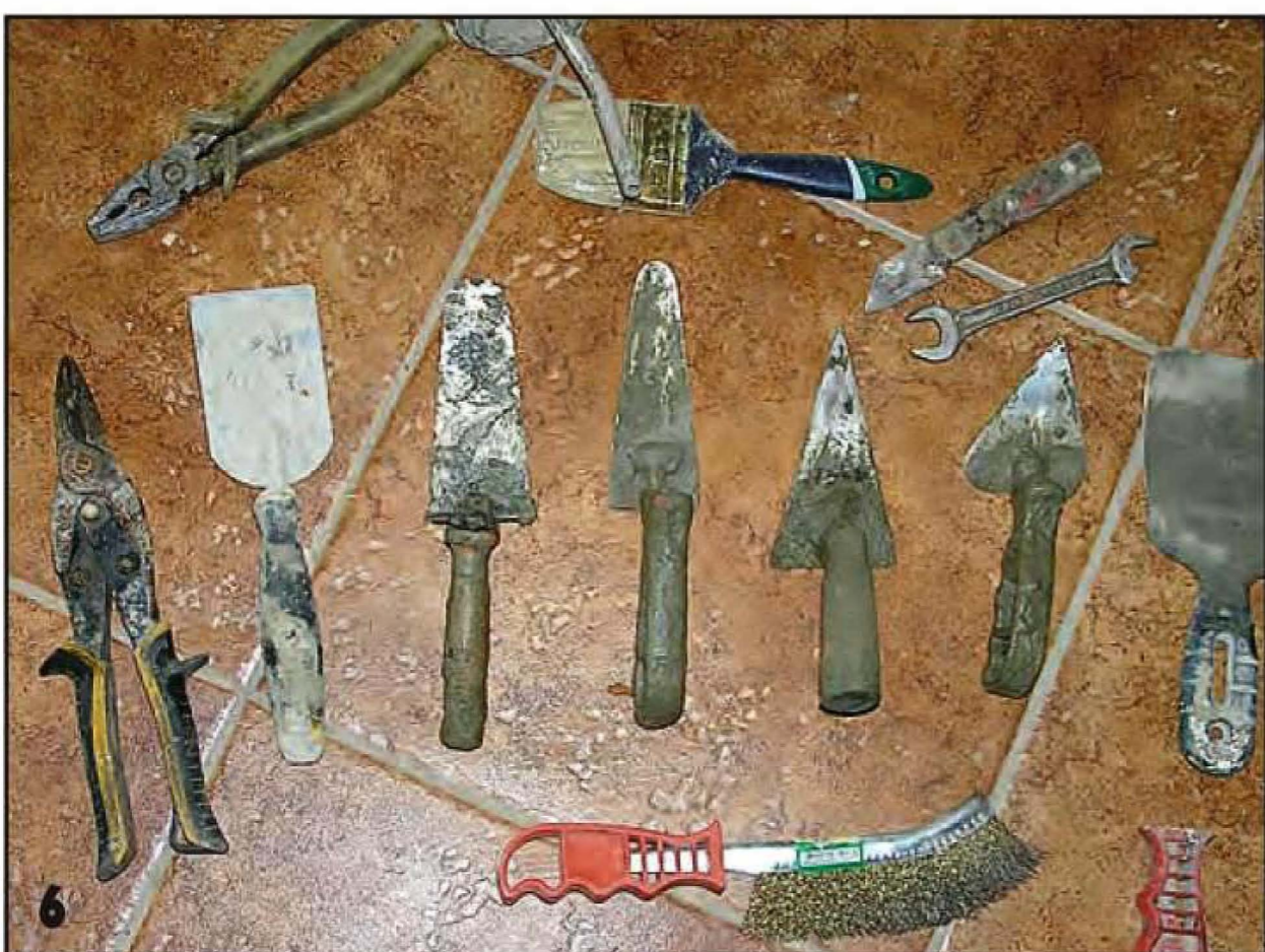
В нашей работе мы используем в основном самодельные шпатели, мастерки и гладилки.
